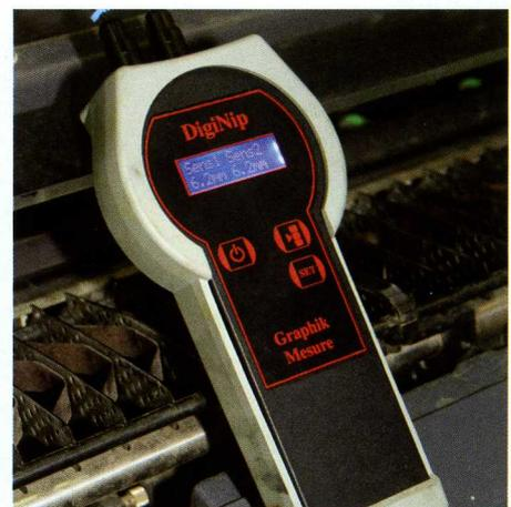
Das Messgerät zeigt die Daten in Millimetern oder in Milli-Inch an, mit einer Toleranz von +/- 10 % bei 0,1 mm.
