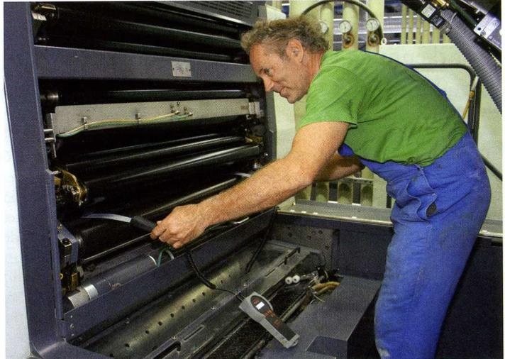
wechsel kurz geprüft. Die kurze Prüfung dauert nur wenige Sekunden, wenn alles stimmt, und gibt so eine entsprechende Sicherheit. Norbert Braunagel: »Grundsätzlich messen wir öfter die Feuchtwerkwalzen nach, da sich eine Abweichung hier stärker bemerkbar macht, als im Farbwerk.«
